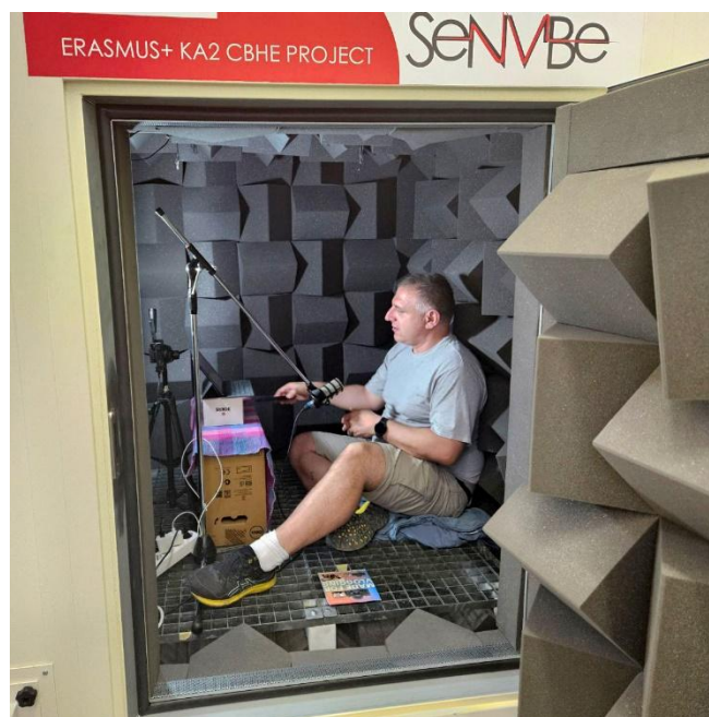
Slika 2. Postavka opreme tokom snimanja u anehogenoj komori.
